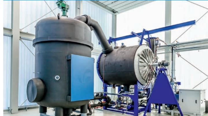
Kältespeicher mit Vakuum-Flüssigeis
