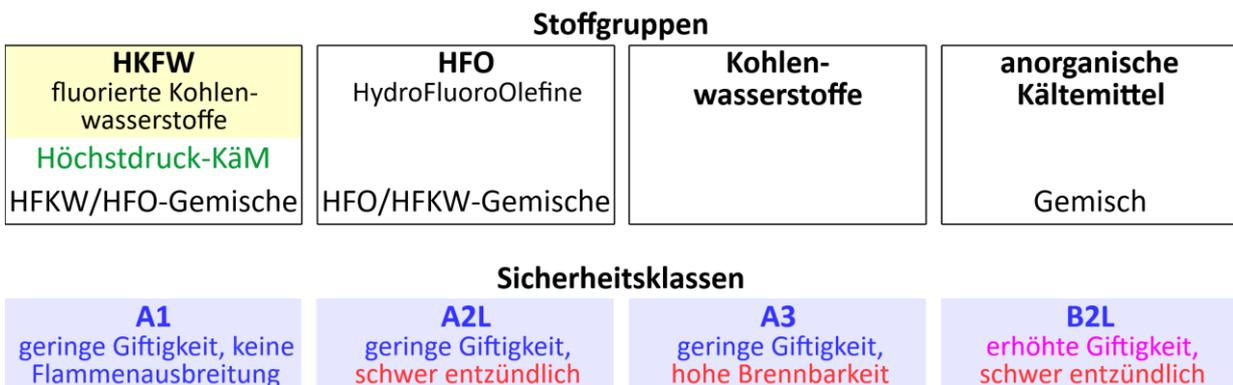
Abb. 3: Klassifizierung von Kältemitteln nach Stoffgruppen und Sicherheitsklassen
